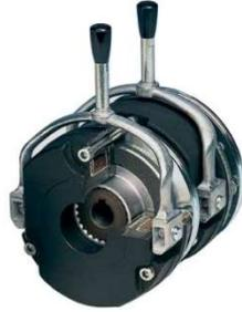
So steht das durch Reibschluss erzeugte Bremsmoment im stromlosen Zustand auch bei Netzausfall zur Verfügung. Das Lösen der Federkraftbremse erfolgt elektromagnetisch.
